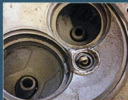
Hauchfeine Präzisions-Schweißnähte. Lasertechnik ermöglicht auch diffizile Reparaturansätze bei echten Problemfällen
